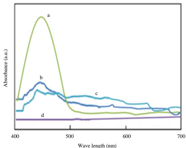
Fig. 5: UV-vis diffuse reflectance spectra of (a)  $\text{AG}_3\text{PO}_4$ , (b)  $\text{AG}_3\text{PO}_4/\text{MCM-41}(\text{DS})$ , (c)  $\text{AG}_3\text{PO}_4/\text{MCM-41}(\text{PS})$  and (d) MCM-41
