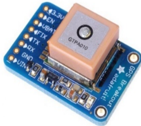
Fig. 10: GPS module (commons.wikimedia.org, 2018)
