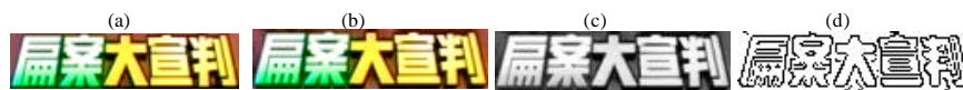
Fig. 3: (a) Original image, (b) extended image, (c) grayscale image and (d) Canny edge map
