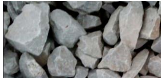
Fig. 4: Actual shape of stone ballast
