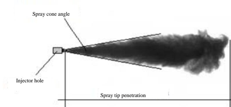
Fig. 2: Spray parameters
